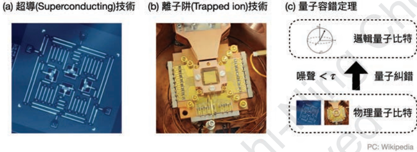
Figure (量子電腦的實作與量子容錯定理). (a)利用超導(superconducting)技術實現量子比特，例如Google, IBM, D-Wave等公司。(b)利用離子阱(trapped ion)實現量子比特，例如Quantinuum、IonQ、鴻海等公司。(c)量子容錯定理在理論上展示一旦能夠將噪聲降的夠低，就可以透過量子糾錯技術將物理比特有效率地轉換成演算法需要的邏輯比特。
