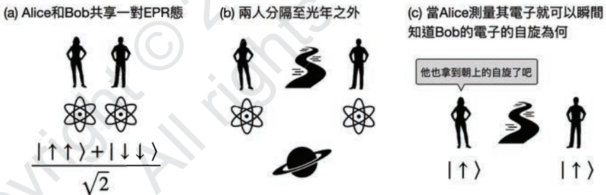
Figure (EPR悖論). (a) Alice和Bob兩人先見面，共同準備一對EPR態，並且各自拿其中的一個電子。(b) 接著兩人被分隔至光年之外，在光速是有限的情況下無法即時的通訊。(c) 當其中一人(例如Alice)測量了她拿的電子，在看到自旋結果的瞬間，她也將會知道對方電子的自旋方向。
